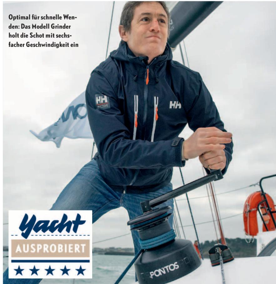
Optimal für schnelle Wenden: Das Modell Grinder holt die Schot mit sechsfacher Geschwindigkeit ein
