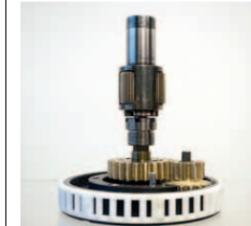
*Ein Planetengetriebe auf der Hauptwelle verdoppelt die Zahl der Gänge, es wird über eine stabile Klauenkupplung zugeschaltet*
