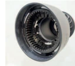
*Der Antriebszahnkranz kann sich in der Trommel um etwa zehn Grad drehen und bedient je nach Last auf der Schot die Kupplung*
