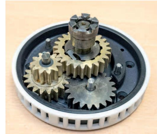
*Getriebe und Sperrklinken der Wischen entsprechen dem erprobten Zweigang-Standard. Je nach Last auf der Schot schaltet sich eine robuste PLANETEN-STUFE davor*
